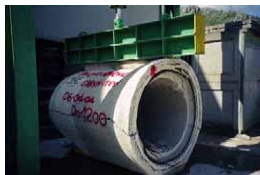
"Test di schiacciamento UNI EN 1916"
